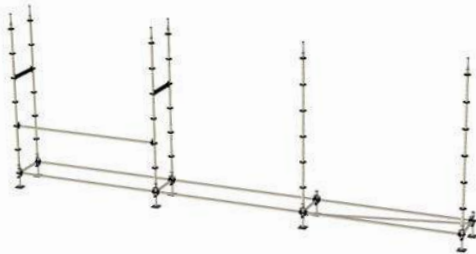
Horisontal diagonal monteras i ett av facken. Högre upp ersätts dessa av full inplankning med planklås.
